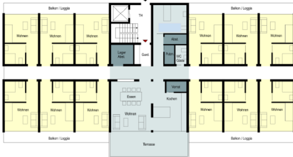
Abb. 2.2: Umgebauter Bestand, mehrgeschossig WG mit 12 Bewohnerzimmern auf einer Ebene Gemeinschaftsbereich = umgebaute ehem. Zimmer
